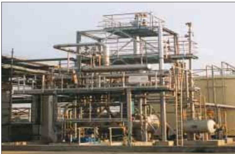
kombinierte Abluftreinigungsanlage für eine Abluftmenge von 6000 m<sup>3</sup>/h
