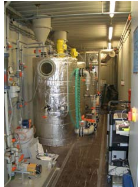
BCM-Bio Biogasanlage 2010; Agrargenossenschaft Wittenberg; Musteranlage für Gemeinden zur Eigenversorgung mit Erdgas aus NawaRo
